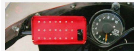
Puesto de mandos típicamente de carreras... a la antigua usanza. Tacómetro, soporte de toma de tiempos, y nada más.
