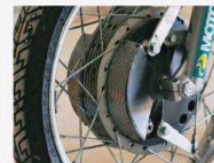
Los tambores, de 210 mm de diámetro, los firma AJR. En el delantero la maneta consigue accionar cuatro levas.
